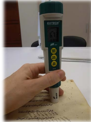
Foto. 44: pH metre ile ölçüm
